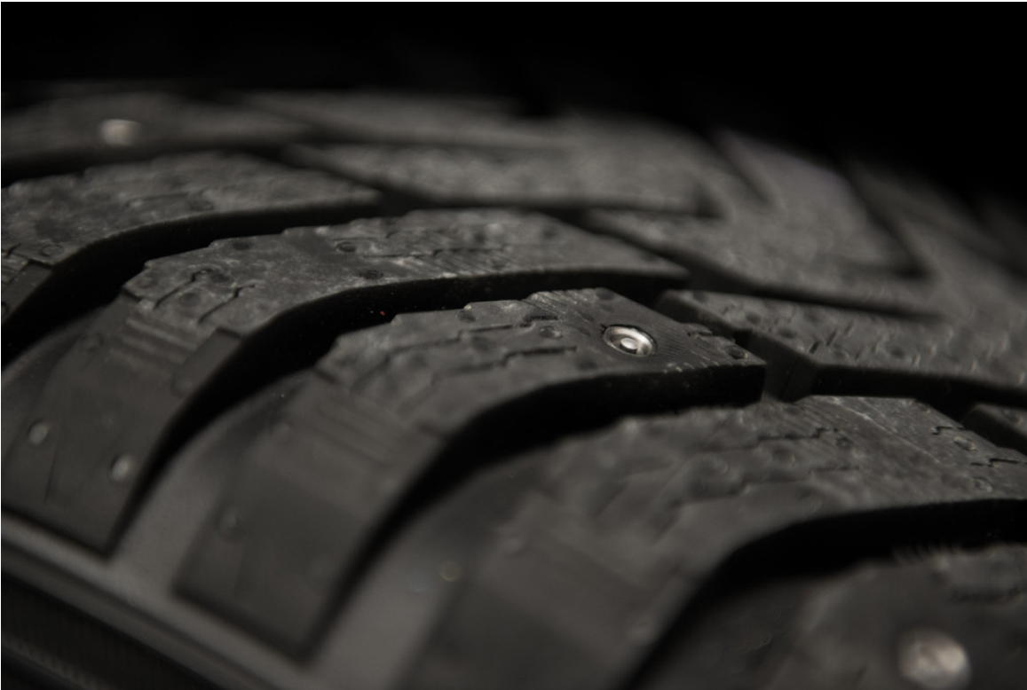
Nokian-Konzeptreifen mit ausfahrbaren Spikes.
