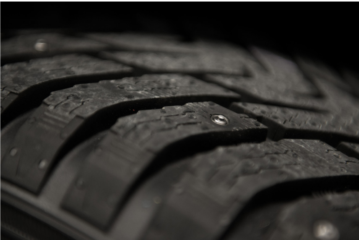
Nokian-Konzeptreifen mit ausfahrbaren Spikes.
