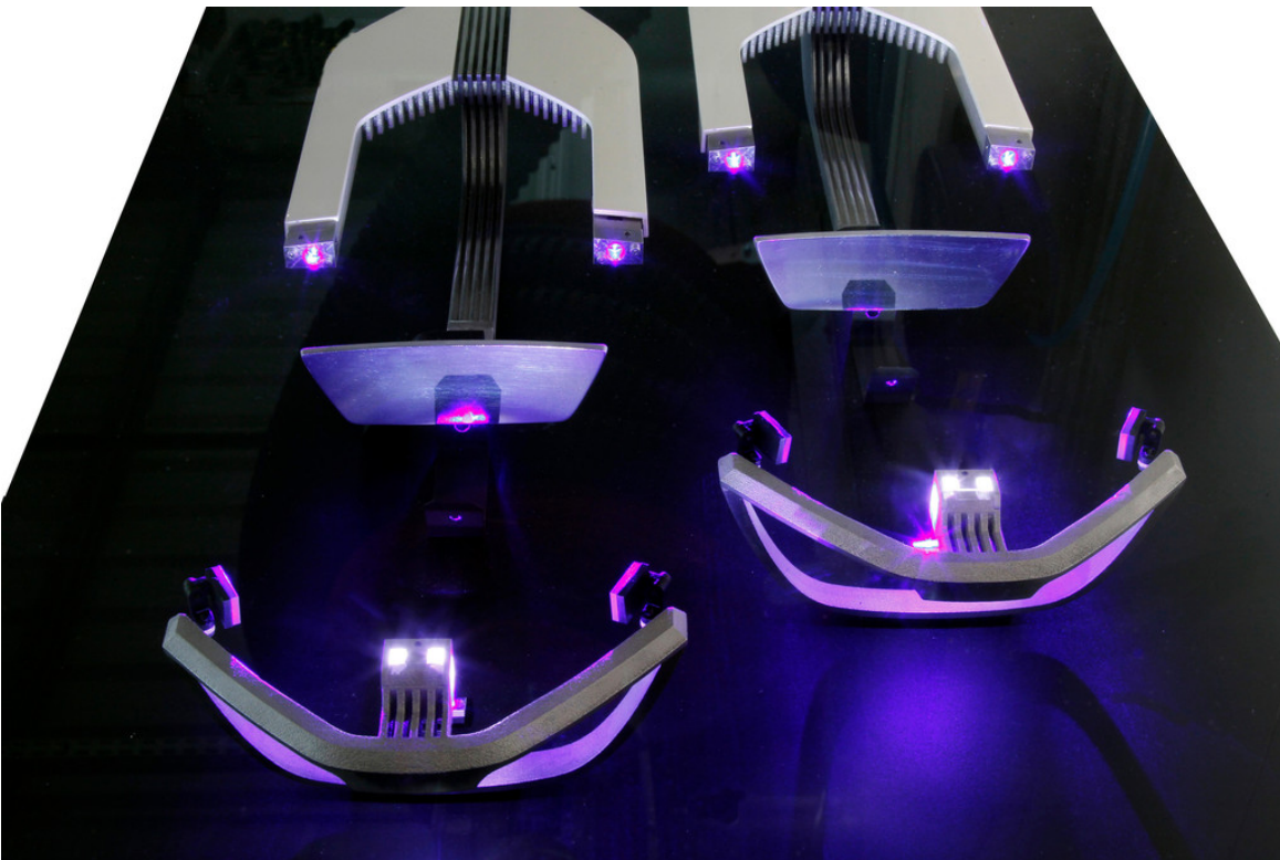
Laserlicht: der Aufbau der beiden Laserscheinwerfer.
