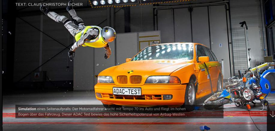
Simulation eines Seitenaufpralls: Der Motorradfahrer kracht mit Tempo 70 ins Auto und fliegt im hohen Bogen über das Fahrzeug. Dieser ADAC-Test bewies das hohe Sicherheitspotenzial von Airbag-Westen
