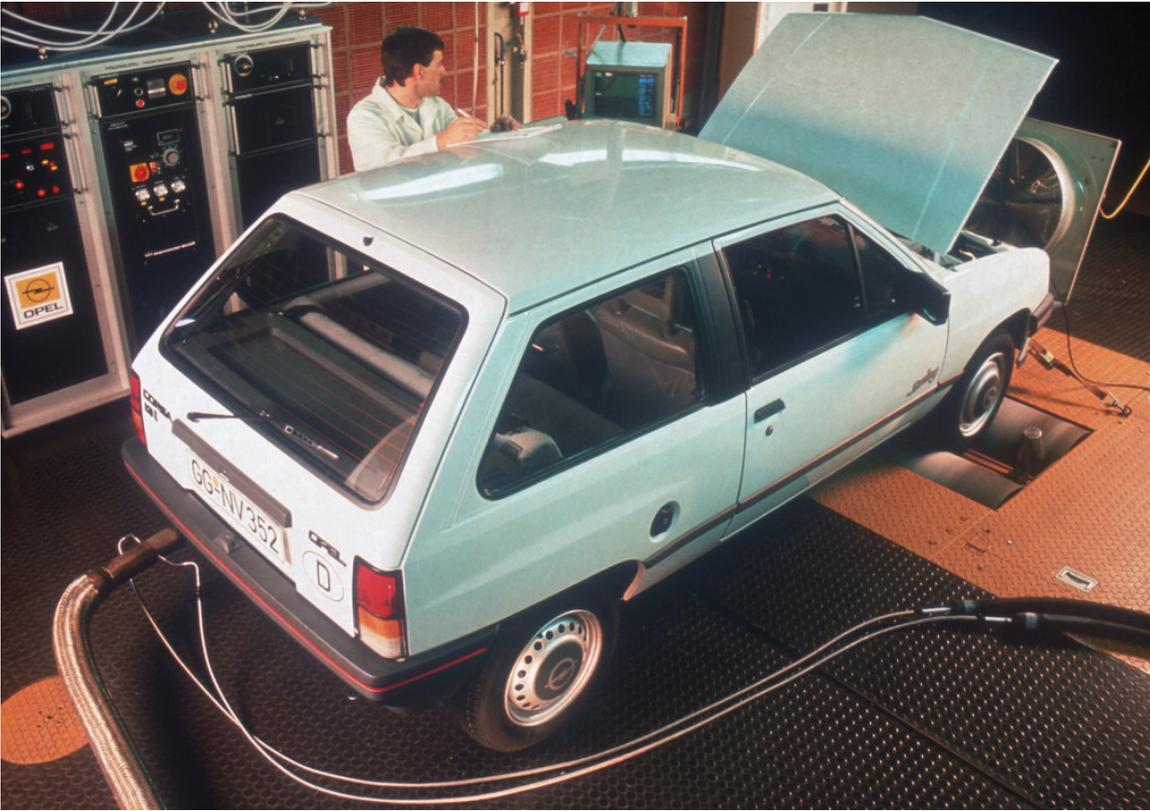
Auf dem Abgasprüfstand untersuchten Opel-Ingenieure Ende der 80er-Jahre die Schadstoffemissionen verschiedener Motorkonzepte. Der geregelte Katalysator reduziert die Schadstoffmengen auf rund ein Zehntel.
