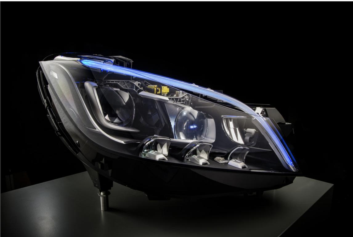
Multibeam-Scheinwerfer des Mercedes-Benz CLS-Klasse mit 24 einzelnen Hochleistungs-LEDs.
