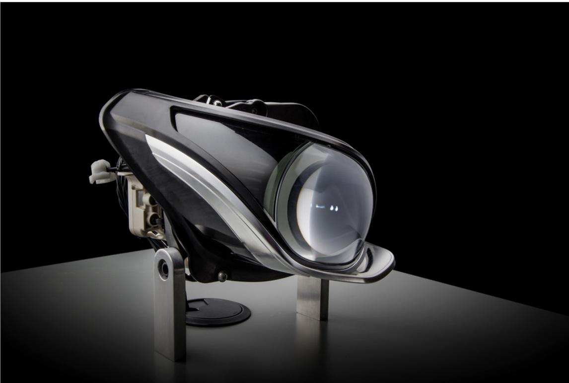
Multibeam-Scheinwerfer von Mercedes-Benz mit 84 LEDs.
