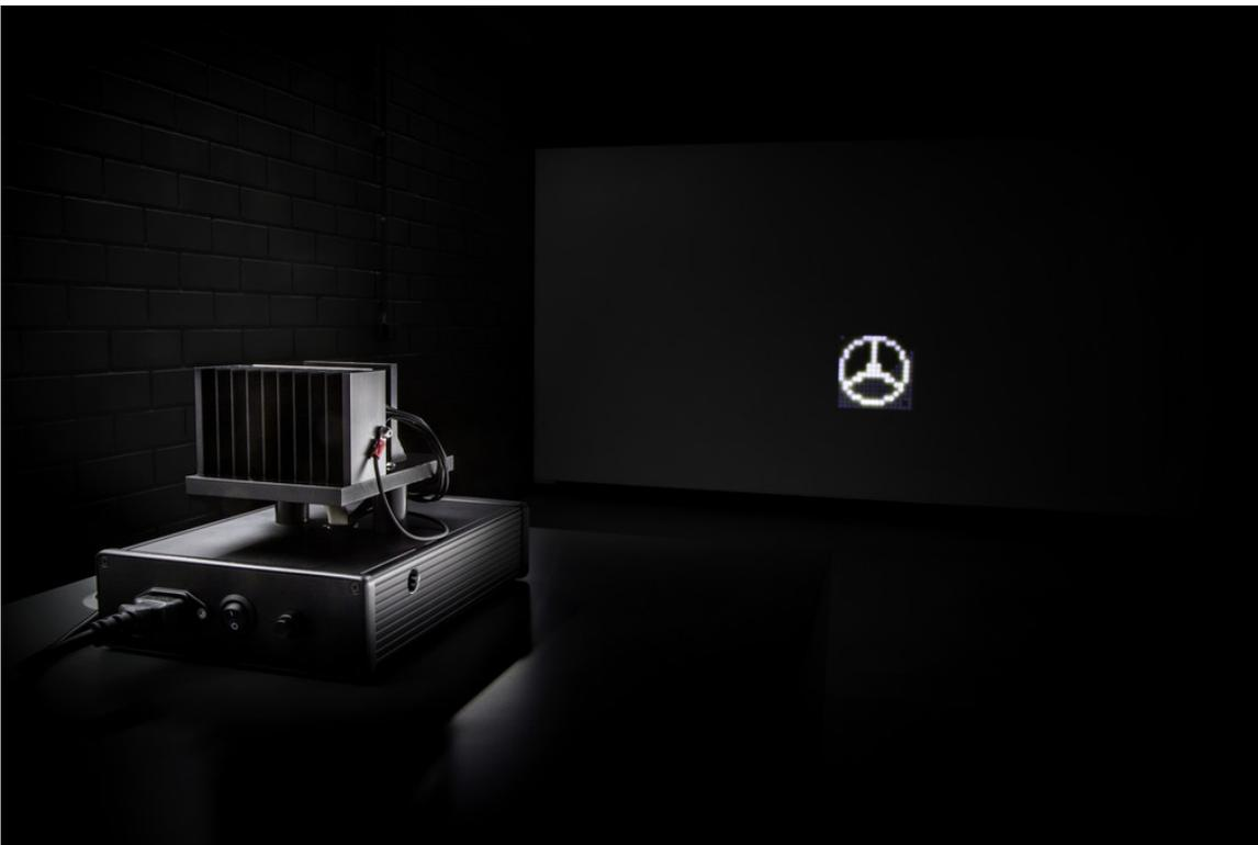
Multibeam-LED-Scheinwerfer: Mittelfristig erlauben 1024 einzeln ansteuerbare Pixel pro LED eine weitere Steigerung der Sichtverhältnisse bei Nacht und damit einen weiteren
