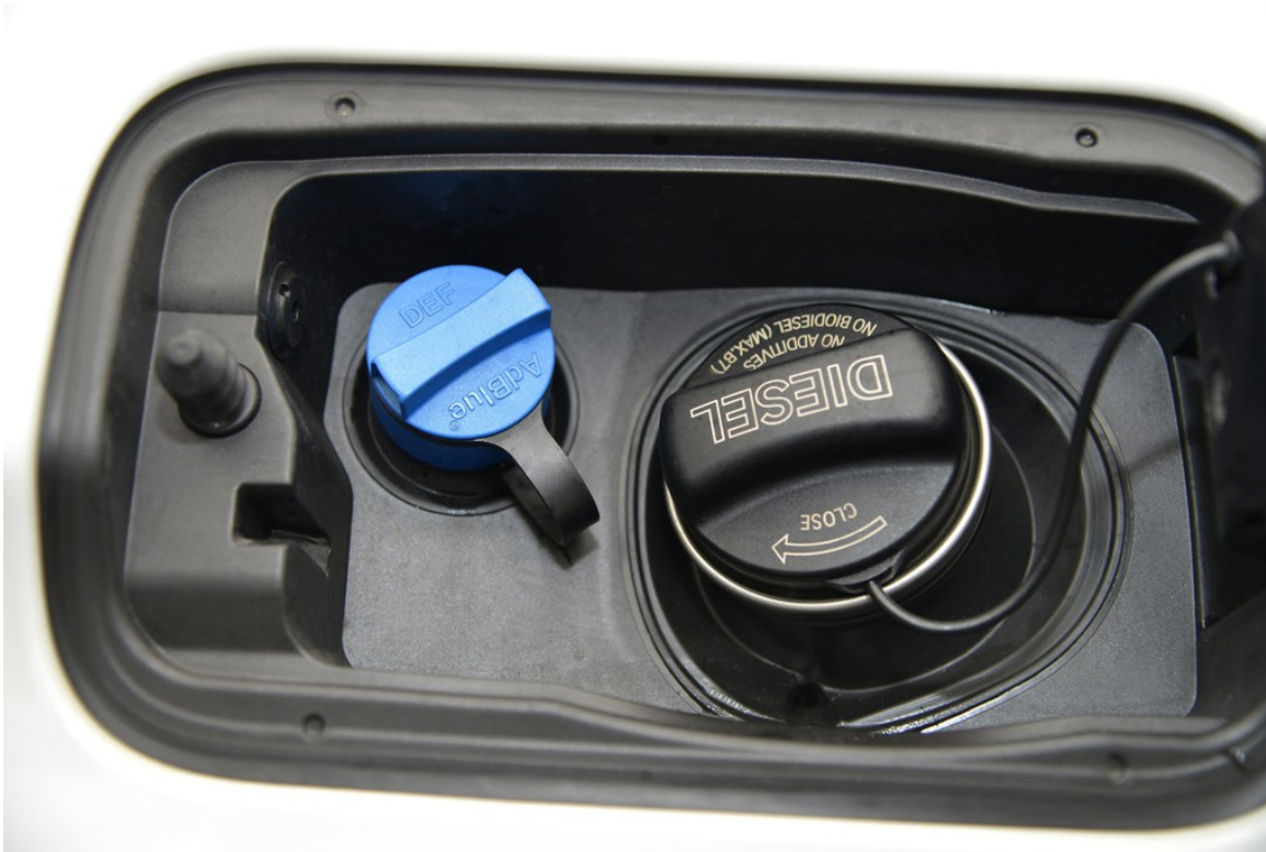
Einfüllstutzen für Adblue (links).
