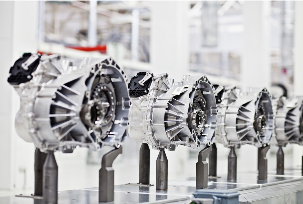
Doppelkupplungsgetriebe DQ 200 des Volkswagen-Konzern.
