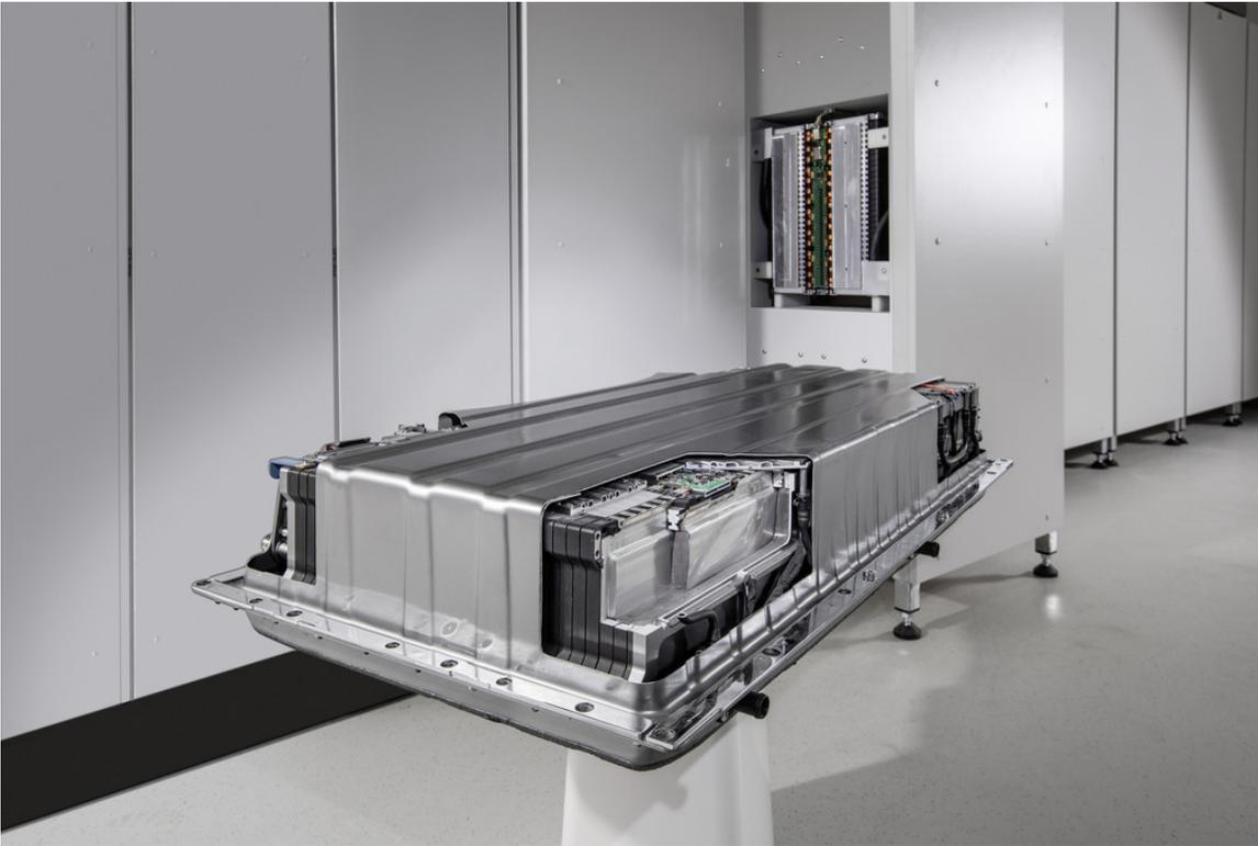
Aus dem Auto ans Netz: Entwickelt für den Einsatz im Fahrzeug (vorne) lassen sich die Energiespeicher von Mercedes-Benz auch stationär (im Hintergrund) nutzen.
