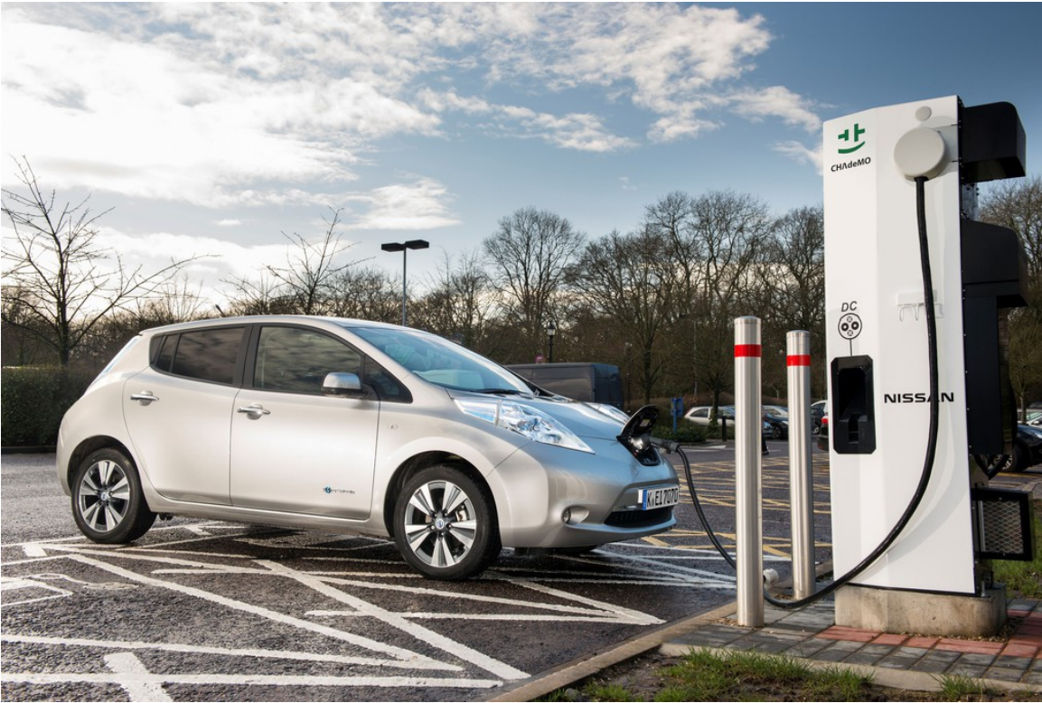
Schnellladestationen nach CHAdeMO-Standard.
