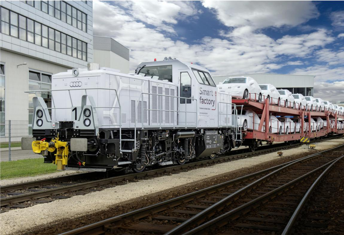
Die Plug-in-Hybrid Lokomotive im Audi-Werk.
