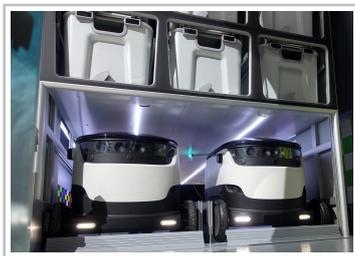
Mothership-Concept (Mutterschiff-Konzept) von Mercedes-Benz und Starship Technologies: Ein Sprinter dient acht Robotern als mobiler Belade- und Transport-Hub.
