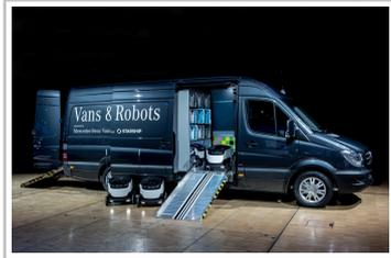
Mothership-Concept (Mutterschiff-Konzept) von Mercedes-Benz und Starship Technologies: Ein Sprinter dient acht Robotern als mobiler Belade- und Transport-Hub.
