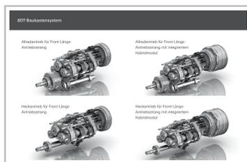
Das Acht-Gang Doppelkupplungsgetriebe von ZF hat einen modularen Getriebekonstruktion für vier unterschiedliche Varianten (Standard, Allrad, Hybrid, Allrad-Hybrid).
