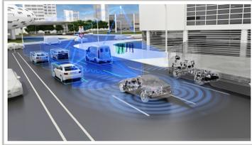
Die Sensorik hat alles im Blick mit Ultraschall, Kameras, Laser, Radar und Lidar.
