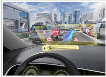
Basierend auf der Technologie des holografischen Wellenleiter erlaubt das neue Head-up-Display eine größere Projektionsfläche bei gleichzeitiger Reduktion des Einbauvolumens.
