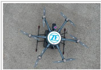
Die von ZF im Werksverkehr eingesetzte automatisierte Transportdrohne ist 30 km/h schnell und hat eine reine Nutzlast von drei Kilogramm.
