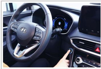
Hyundai hat eine Technologie entwickelt, mit der sich das Fahrzeug per Fingerabdruck öffnen und starten lässt.
