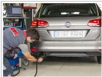
GTÜ-Prüfingenieur bei der Abgasmessung am Endrohr.
