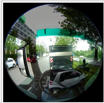
Simulation: Mit Hilfe einer Virtual-Reality-Brille und Stereokameras macht ein neuartiges System das Fahrzeugcockpit gewissermaßen durchsichtig, so dass der Fahrer alle Hindernisse direkt und dreidimensional an ihrer realen Position sehen kann. Kameraaufnahme und reale Sicht überlagern sich. Es handelt sich bei der Aufnahme um das linke Bild einer 180-Grad-Stereobildaufnahme.
