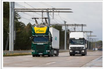
Siemens baut auf einem Testfeld auf der A 5 bei Frankfurt eine Oberleitung für Hybrid-Lkw.
