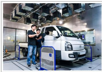
Hyundai hat ein System entwickelt, das das Drehmoment beim Elektroantrieb eines leichten Nutzfahrzeugs nach dessen Beladungszustand regelt.
