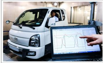
Hyundai hat ein System entwickelt, das das Drehmoment beim Elektroantrieb eines leichten Nutzfahrzeugs nach dessen Beladungszustand regelt.
