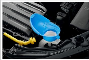
Trichterförmiger Verschlussdeckel des Waschwasserbehälters von Skoda.
