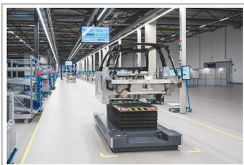
E-Go-Fertigung mit automatischen, fahrerlosen Transportsystemen.
