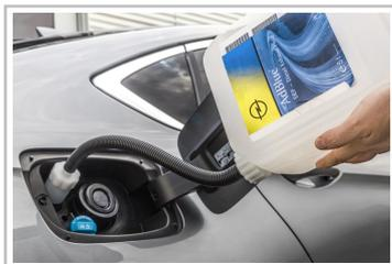
Befüllen des Adblue-Tanks.
