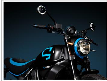
Motorradspiegel von Gazzini mit integriertem Tagfahrlicht.
