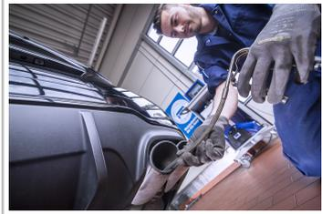
Abgasuntersuchung: Messung am Endrohr.
