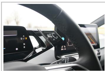
VW ID 3: VW ID 3: Der Wählhebel liegt versteckt hinter dem Lenkradkranz.
