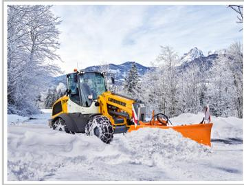
Mit dem Vredestein Flotation Trac und Schneeketten bereift: Liebherr L 509 Tele mit Schneepflug.
