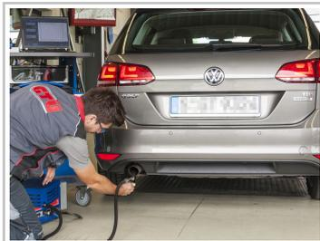
GTÜ-Prüfingenieur bei der Abgasmessung am Endrohr.
