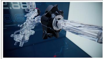
Automatisiertes Schaltgetriebe Y-AMT von Yamaha.
