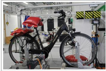
ADAC-Test Pedelecs: Reichweitenermittlung auf dem Prüfstand.
