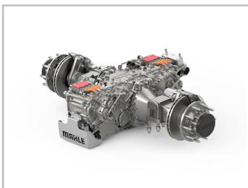
E-Achse von Mahle mit zwei Motoren für schwere Lkw und 520 kW Spitzenleistung.
