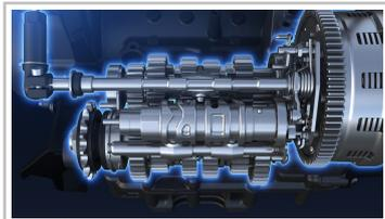
Y-AMT: automatisiertes Schaltgetriebe von Yamaha.
