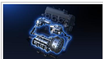
Y-AMT: automatisiertes Schaltgetriebe von Yamaha. Zwei elektrische Motoren übernehmen die Arbeit von Kupplung und Schaltung.
