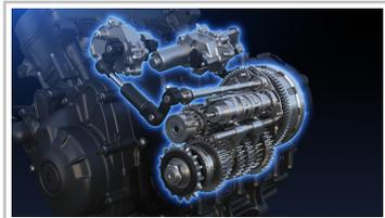
Y-AMT: automatisiertes Schaltgetriebe von Yamaha.
