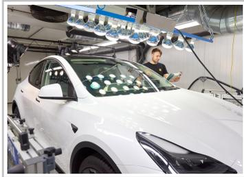
Tesla Model Y in der ADAC-Klimakammer: UV-Lampen simulieren die Sonneneinstrahlung.
