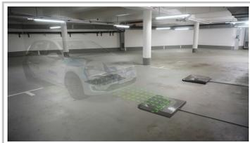
Mahles Positionierungssystem DIPS für induktives Laden von Elektrofahrzeugen.
