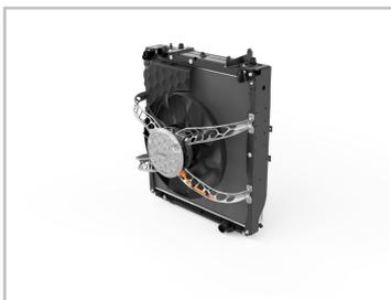
Mahle hat einen Lüfter für Elektrofahrzeuge entwickelt, dessen Blätter sich an den Flügeln von Eulen orientiert: Auch die Träger und die Abdeckung folgen dem bionischen Prinzip, um Gewicht zu sparen und die Strukturfestigkeit zu erhöhen.
