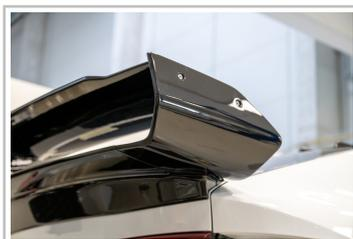
Der Heckflügel des Konzeptfahrzeugs Skoda Enyaq RS Race ist aus Biokomposit gefertigt.
