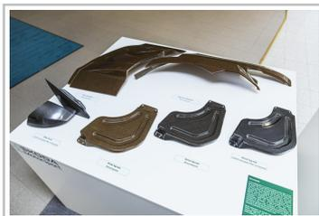
Fußstützen, Außenspiegelverkleidungen oder Karosserieverbreiterungen aus Biokompositwerkstoffen helfen, den Kohlefaser-Fußabdruck der Rallye-Fahrzeuge von Skoda zu reduzieren.
