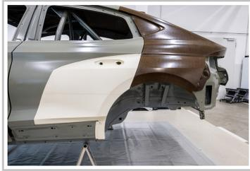
Das Heck und Teile des Dachs des Skoda Enyaq RS Race bestehen ebenso wie Außenspiegel, Interieurkomponenten und Seitenschweller aus Flachfasern.
