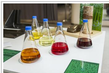
Skoda Motorsport arbeitet an Betriebsstoffen, die auf fossilfreiem Rohmaterial basieren. Sie sollen Flüssigkeiten wie Motor-, Getriebe- oder Stoßdämpferhydrauliköl ersetzen.
