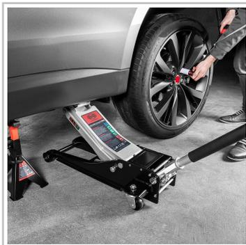
Reifenwechsel mit Hilfe eines Rangierwagenhebers.
