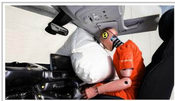
ZF Lifetec arbeitet an Lösungen, bei der passive Sicherheitssysteme wie der Airbag und der Sicherheitsgurt künftig erkennen, wie groß oder schwer die gerade im Fahrzeug befindliche Person ist oder welche Sitzposition sie genau eingenommen hat.
